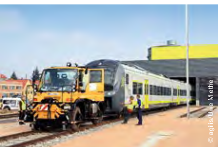
Der Zwei-Wege-Unimog ermöglicht einfaches Rangieren der Züge
